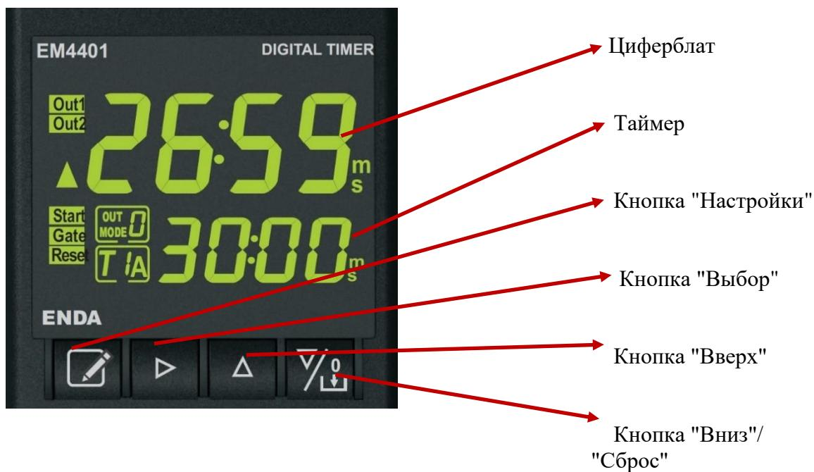
Настройка таймера: Нажмите кнопку «настройки» один раз, дождитесь, пока цифры замигают. Используйте кнопку «выбора» для выбора цифры, используйте стрелки «вверх» или «вниз» для изменения значения времени. Подождите 3 секунды, пока на таймере появится новое время, после чего, нажмите кнопку "Вниз" / "сброс", чтобы сохранить заданный параметр.
